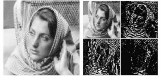
图 3 基于二维形态 Haar 小波变换的多尺度图像分解
